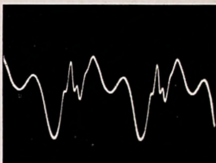
Fig. 10 - Aan de anode van de ECH81 is de puls reeds sterk vervormd
